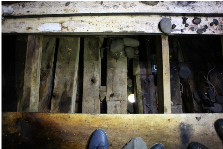
Undir þiljum í Sigurfara, 2017. Böndin á botninum eru svo þétt, að þau eru nálægt því að snertast sumstaðar. Ljós.: HMS
